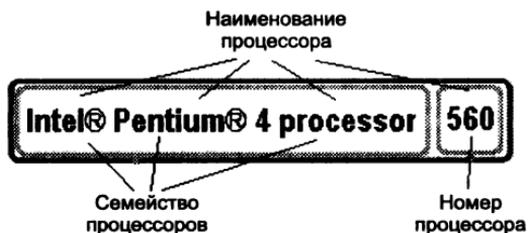
Рис. 3.41. Структура номера процессора
