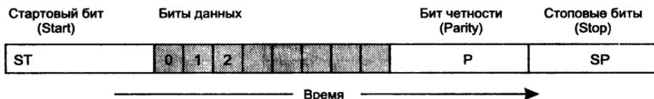
Рис. 4.23. Структура кадра данных при передаче байта информации в стандарте RS-232-C
