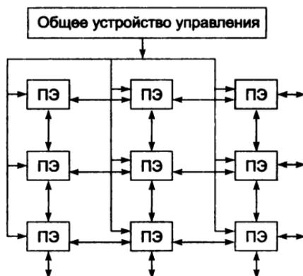
Рис. 2.47. Структура матричной вычислительной системы Solomon
