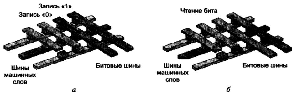
Рис. 4.8. Принцип функционирования MRAM:
