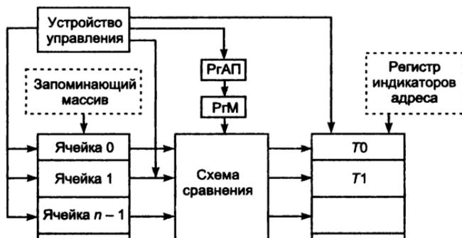
Рис. 3.9. Пример структуры ассоциативного процессора
