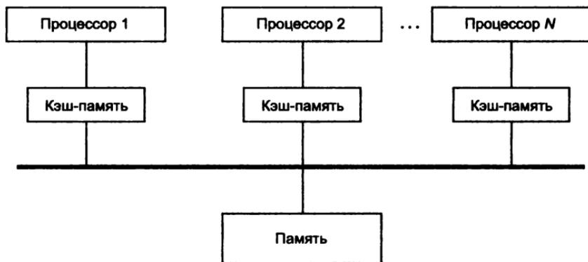
Рис. 2.37. Симметричная мультипроцессорная архитектура
