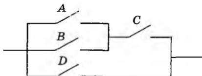
Переключатели  $A$  и  $B$  соединены параллельно, следовательно, этот участок схемы описывается как дизъюнкция переменных:  $A \vee B$ . Далее следует последовательное соединение с переключателем  $C$ :  $(A \vee B) \& C$ . Рассмотренный участок цепи параллельно соединяется с переключателем  $D$ :  $(A \vee B) \& C \vee D$ .  $\square$
