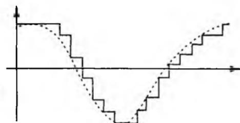
Выходной сигнал, сглаженный фильтром
