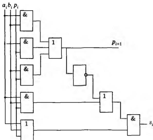
Сложение  $n$ -разрядных двоичных чисел осуществляется с помощью комбинации одноразрядных сумматоров (условное обозначение одноразрядного сумматора приведено на рисунке слева.) В зависимости от способа ввода/вывода данных и организации переносов многоразрядные сумматоры бывают последовательного и параллельного принципа действия.
