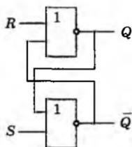
Здесь: вход *S* (set) — установка триггера в 1, вход *R* (reset) — установка триггера в 0.
